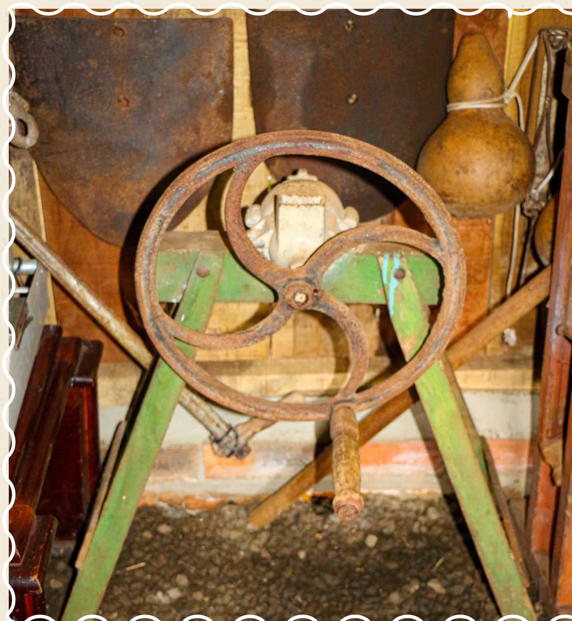
Debulhador de milho manual, muito utilizado pelos produtores rurais até a década de 1980.
